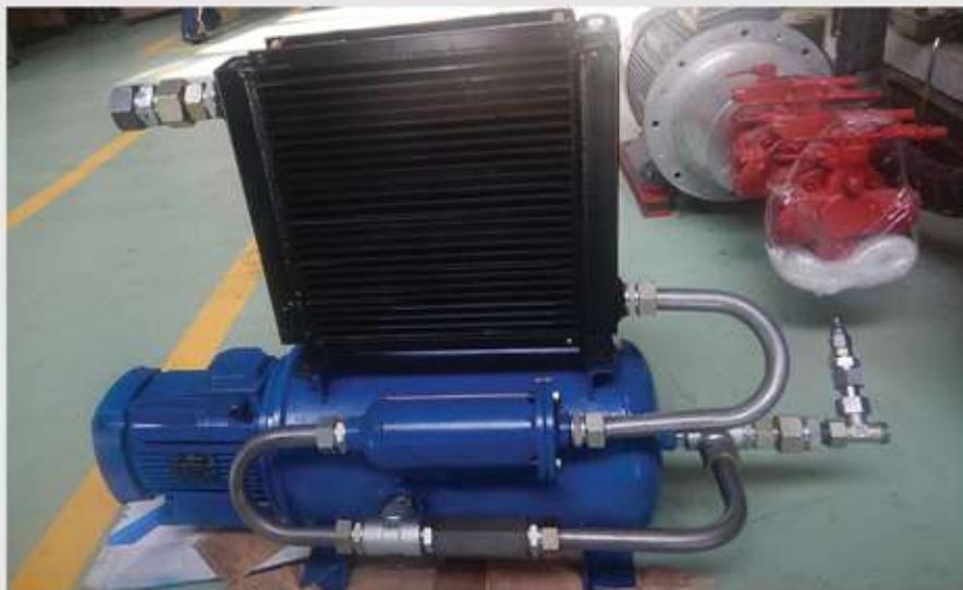
مشخصات و قابلیت‌های پاورپک چکش حفاری هیدرولیکی جهت کار در تونل
