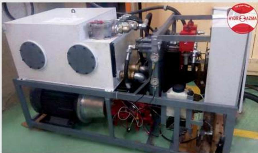
**مشخصات و قابلیت‌های پاوریک تست جک و فلاشینگ:**
